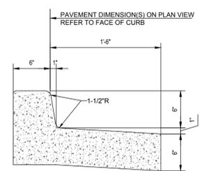
**SPILL CURB & GUTTER**
